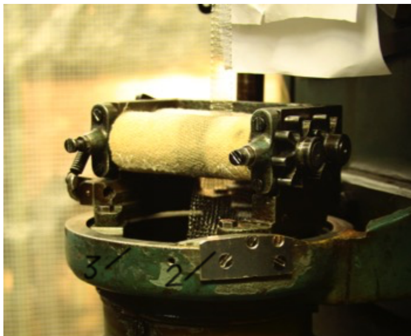
Рисунок 2.7, б - Механизм оттяжки со второй дополнительной накладкой
