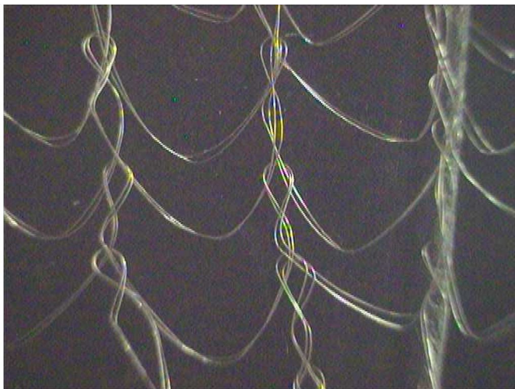
Рисунок 2.19 - Структура трубчатого полотна, выработанного при работе через четыре иглы
