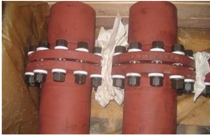
Рисунок 1.2 - Фланцевый способ соединения труб
